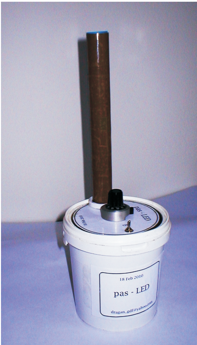
Figura 2. Vedere frontală a ansamblului pas - LED cu tubul ocular fixat în montura LED-ului.
